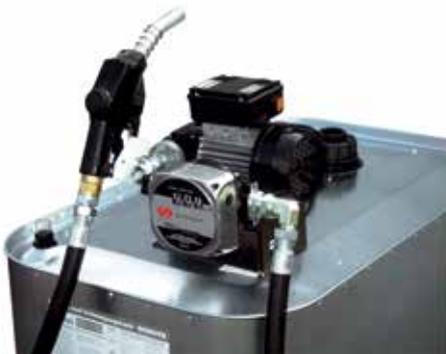
Trocken selbstansaugende Elektropumpe mit Bypass für das schnelle Betanken mit Diesel, Biodiesel und Heizöl inklusive Ein- und Ausschalter mit Leuchtanzeige, Zapfpistolenhalter AP.
