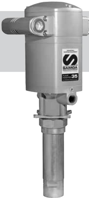
Doppeltwirkende Druckluft-Mitteldruckpumpen für Ölverteilungsanwendungen. Die Pumpen verfügen über einen höhenverstellbaren 2" BSP (M)-Spundlochadapter für die Montage in Fässern und Tanks und einen integrierten Anschluss für ein optionales Druckbegrenzungsventil (609007).
