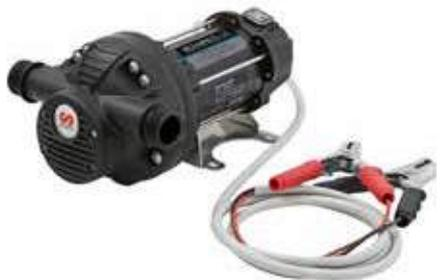
**560224** Die 12 V-DC, 24 V-DC- und 230 V-AC-Membranpumpen eignen sich für die Abgabe von AdBlue®/DEF. Die Pumpen sind selbstansaugend und haben ein Bypass-Ventil. Die Antriebsmotoren haben die Schutzart IP 55 und beinhalten einen Ein-/Ausschalter, eine Sicherung und ein 2 m langes Kabel mit Krokodilklemmen (Gleichstrompumpen) oder Stecker (Wechselstrompumpen).
