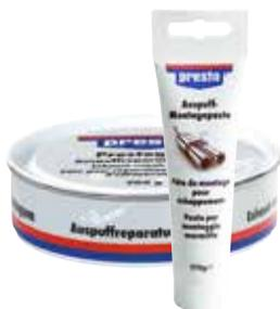
presto Auspuff-Montagepaste ist eine kittartige Paste auf Wasserglasbasis zum Abdichten von Verbindungsstellen wie Muffen, Klemmen, Schellen. Die Paste kann reichlich auf die zu bearbeitenden Stellen aufgetragen werden, danach kann sofort der Zusammenbau der Teile durchgeführt werden. Die Aushärtung erfolgt durch Erhitzung. Gewährleistet problemlose Montage und Demontage von Auspuffteilen.
