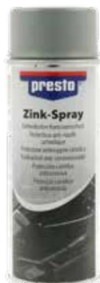
Zinkspray nach DIN 50976 mit über 91% Zink im Trockenfilm. Bereits beim Aufsprühen eines Kreuzgangs ergibt sich eine Schichtstärke bis 90 µm. Daher besondere Rostschutzwirkung auf allen eisenhaltigen Metallen.
