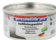
prestolith pro Softfeinspachtel ist ein hochelastischer, schnell härtender 2-komponentiger Polyester-Feinspachtel, als Mischung eines hochreaktiven, ungesättigten Polyesterharzes, gefüllt mit einer neuartigen Pigment-Füllstoff-Kombination. Zum Ausfüllen von Unebenheiten und zum dünnen „Feinspachteln“ schon vorbehandelter Flächen.
