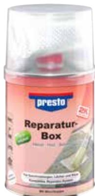
Die presto Reparaturbox ist eine Reparaturpackung mit ungesättigtem, elastifiziertem Polyesterharz, Härter, sowie Glasfasergewebe und Glasfaservlies. Zum Überbrücken größerer Löcher, Durchrostungen und Schadstellen.
