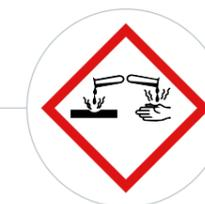
Verätzungsgefahr: Batteriesäure ist stark ätzend. Deshalb: Schutzhandschuhe und Augenschutz tragen. Batterie nicht kippen, aus den Entgasungsöffnungen kann Säure austreten!
