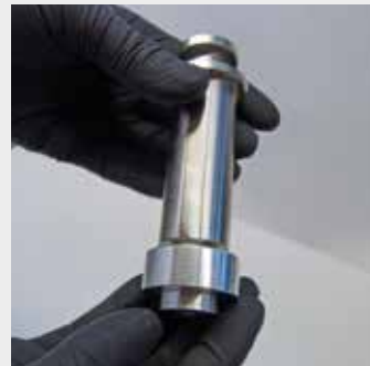
10. Den Teflonkolben gegen den Metallkolben austauschen
