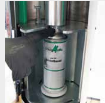
12. Dose und aufgesetzten Zylinder ganz nach hinten drücken
