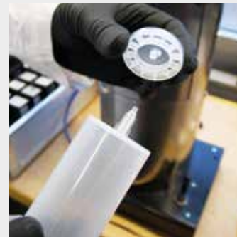
3. Deckel des CleanJectors abnehmen
