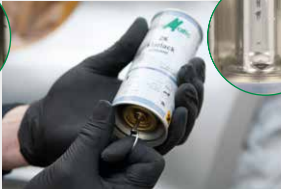
4. Kräftig ziehen und einmal um 360° drehen. Das Messer im Inneren schneidet die Kartusche auf.
