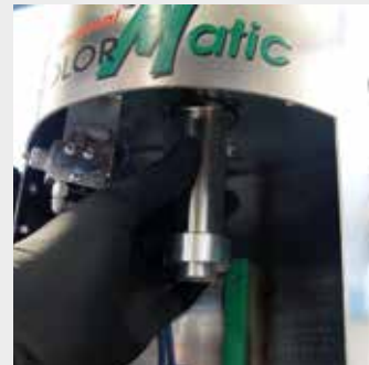
11. Kolben und Kolbenstange einsetzen
